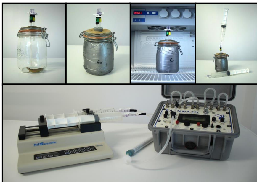
Figure 11 : Illustration du protocole de mesure du \dot{V}O_2 en circuit fermé.
