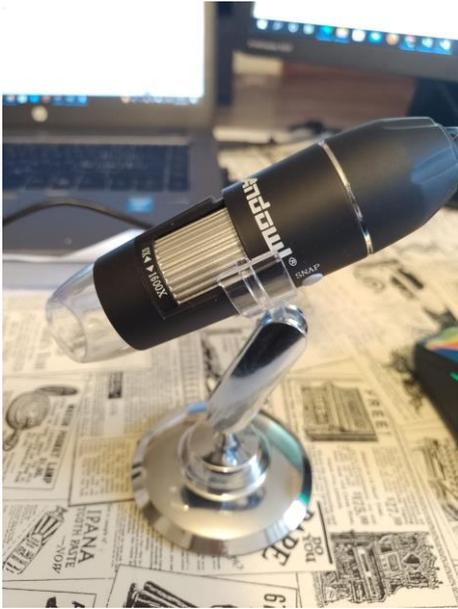
**Figura 33.** Microscopio digitale Andowl QY-X03, ingrandimento fino a x1600, utilizzato per l'osservazione di pori femorali, ed il riconoscimento tra sessi.
