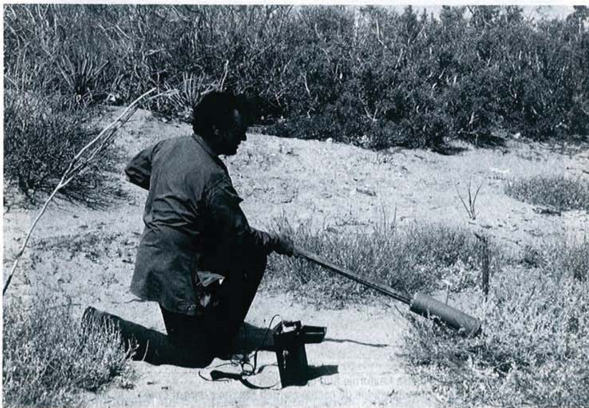
Figure 3 : détection et localisation à l'aide d'un compteur gamma portable (échelle de comptage numérique PSR 8) des lézards injectés au ^{22}\text{Na}
